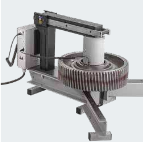
TIH L MB, rulman haricindeki iş parçalarını, modele bağlı olarak, 600 kg'a (1 323 lb) kadar ısıtır.
